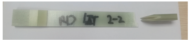
(a) 室温干态拉伸试件破坏模式
